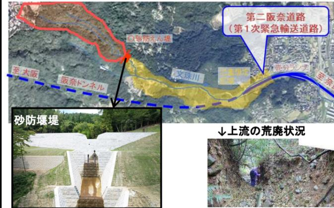
第1次緊急輸送道路である第二阪奈道路及び人家8戸を保全すべく、堰堤工1基を令和4年に完成し、現在は溪流保全工等を施工中。
