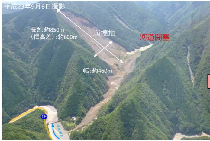
ダム決壊・土石流化を防ぐため、ヘリコプターで輸送してポンプ排水を併用しながら仮排水路の工事を緊急的に実施(H23.9)
