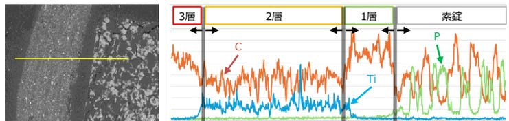
図3-a)線分析箇所と線分析結果(結果はC,Ti,Pを抜粋)
