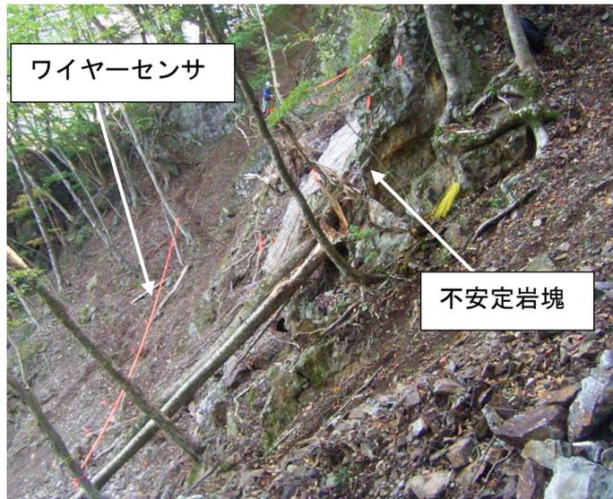
図- 7.8 不安定岩塊直下のワイヤーセンサ設置状況の例
