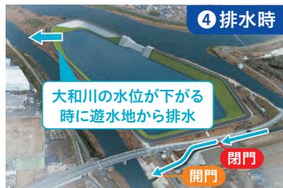
大和川の水を一時的にためて、約23万m<sup>3</sup>の洪水をカット！
