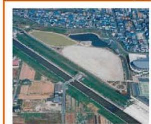
**遊水地** 河川の流水を遊水地内に越流させることにより、下流の氾濫を軽減します。
