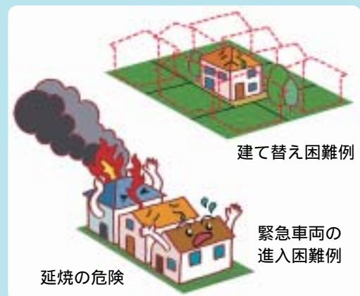
道に面していないため建て替えできない 建物同士が近いので延焼の危険が・・・ 道路が狭いため、救急車や消防車が 進入できない
