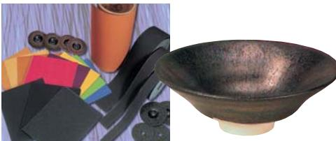
二上山山麓は金剛砂(ざくろ石)の産出地として知られています。天平の頃には金剛砂を用いて玉石を磨いたという記録があり、幕末にはめのう用の研磨材として販売されました。第1次大戦中から軍需品の精密器材用研磨材として発達し、現在は研磨布紙の材料として、また光学レンズ研磨材、ガラス加工用材、石材彫刻材等広範囲な用途開発がなされています。また焼物のうわ薬として使用され「ふたかみ窯」と呼ばれる新製品も開発されています。
