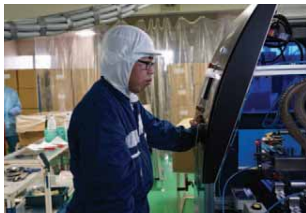
UVシルクスクリーン印刷機の型替え作業 (第一化工株式会社)
