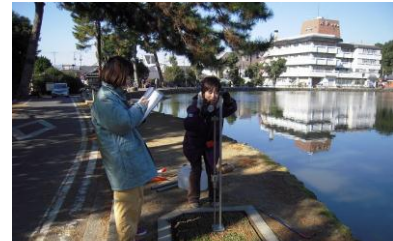
写真-5 長谷川式貫入試験の様子
