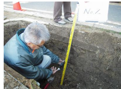
写真-9 山中式土壌硬度試験の様子
