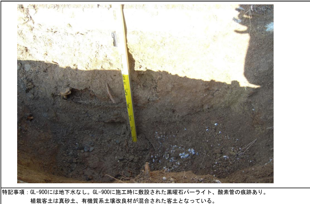
図-4 No.1 地点試孔断面調査結果
